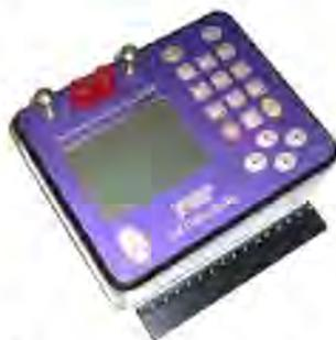
Рисунок 4.3.2 - Электроразведочный измеритель «МЭРИ-24»
