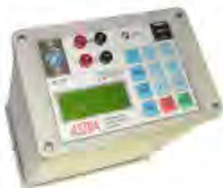
Рисунок 4.3.1 - Электроразведочный генератор «Астра»
