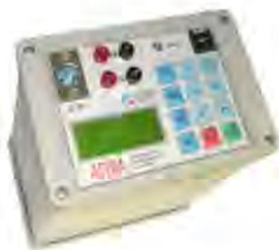
Рисунок 4.3.1 - Электроразведочный генератор «Астра»
